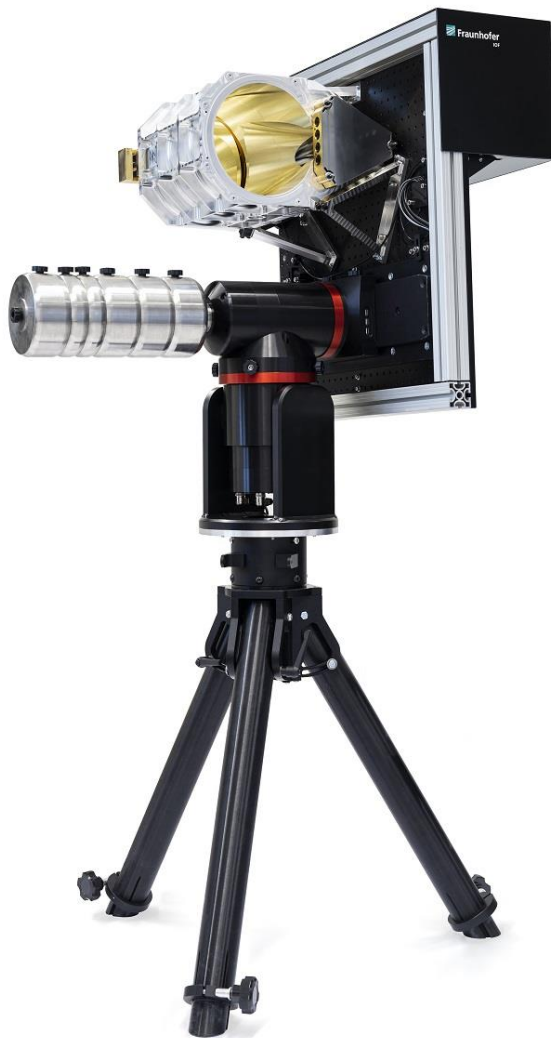
Abb. 4: Ein am Fraunhofer IOF entwickeltes abschattungsfreies Metallspiegelteleskop ermöglicht die kurzfristige Freistrahübertragung zwischen zwei Kommunikationspartnern. So wird z. B. die Quantenkommunikation innerhalb von Städten möglich. (Copyright: Fraunhofer IOF)
